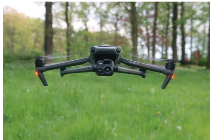
Bonne's drone die beschikt over de nodige technologische snuffjes: een gewone camera, een warmtecamera en een optische zoom.
