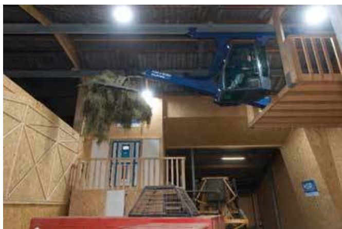
Een kraan met grijper in de nok van de schuur brengt hooi in en uit de hooibox (links).
